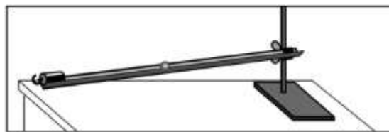
Рисунок 1-Лабораторна установка для визначення прискорення тіла
